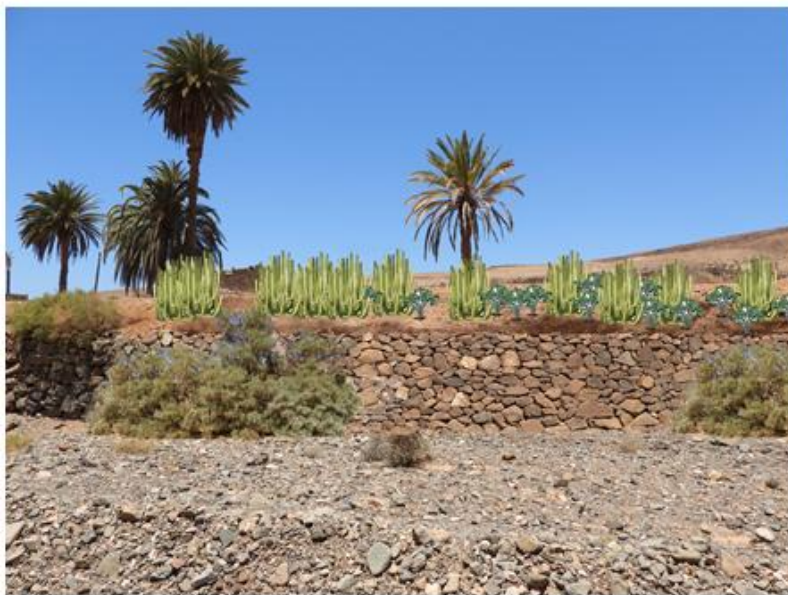
Simulación nº 4.1. Restauración de gavias, reconstrucción de muro de piedra del fondo del barranco, revegetaciones con matorrales xerófilos en laderas adyacentes y de tarajales ( Tamarix canariensis ) en el fondo del barranco.
